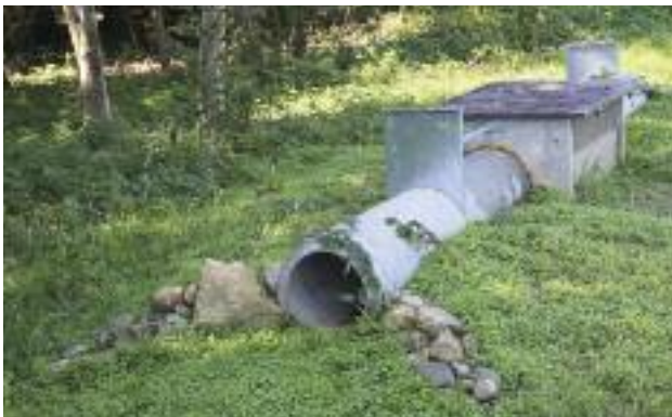
Betonwipprohrfalle System „Trapper“ im noch unverblendeten Zustand.
