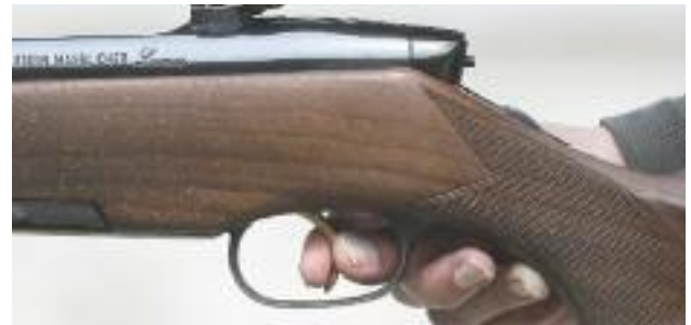
Entstehen eines Rückstechers
