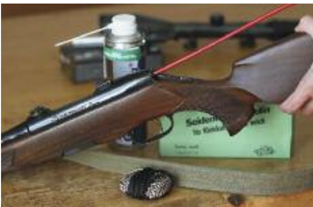
Die Reinigung des Laufs mittels Putzstock erfolgt vom Patronenlager aus. Die verwendeten Öle dürfen nicht harzend und müssen silikonfrei sein.
