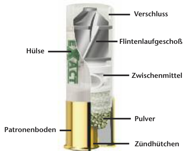
Aufbau einer Flintenlaufgeschößpatrone
