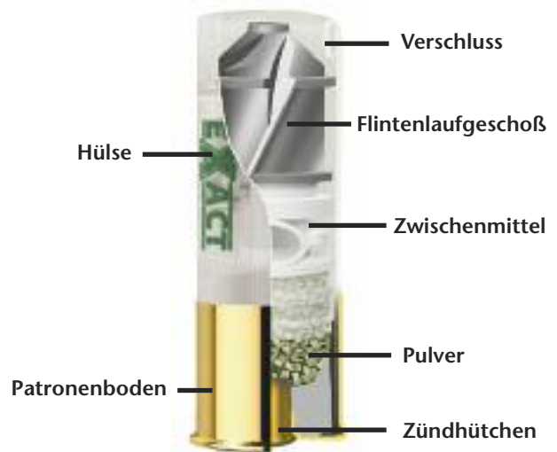
Aufbau einer Flintenlaufgeschößpatrone
