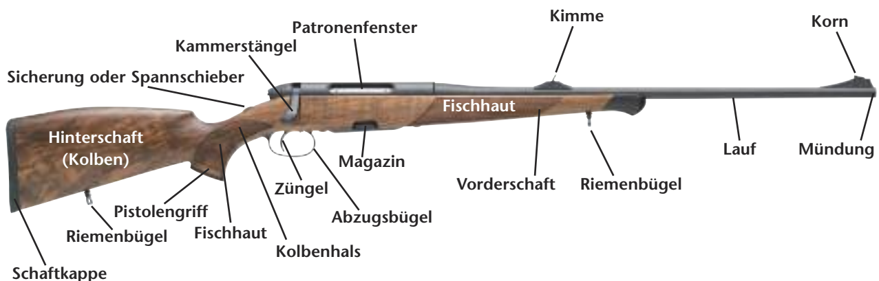
Repetierbüchse mit Drehkammerverschluss und Kolbenhalsicherung. Die Visiereinrichtungen von Büchsen sind u. a. Kimme und Korn und/oder Zielfernrohr.
