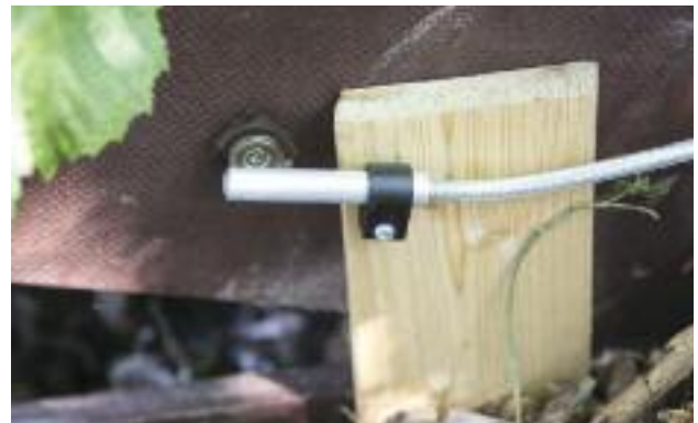
Die Verwendung von Fallenmeldesystemen ermöglicht eine fangzeitpunktnahe Behebung.
