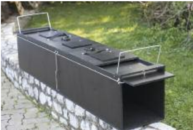
Kastenfalle aus Siebdruckplatten (Durchgehfall)
